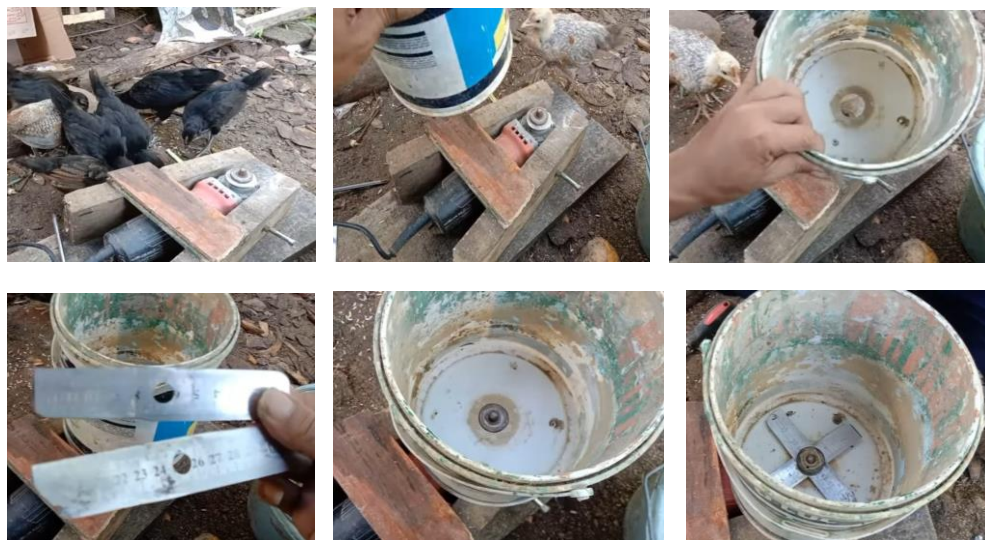
Gambar 2. pembuatan pencacah sampah sederhana
